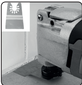
Obr.2, odstraňovanie zvyškov lepidla či tmelu škrabkou
